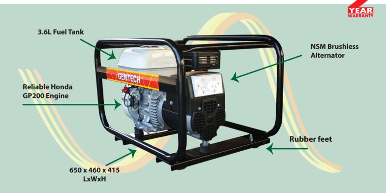
POWER RATING ENGINE STARTING SYSTEM FUEL TANK EP2800HSR 2.8 kVA @ 0.8 pf Honda GP200 Recoil 3.6 Litre FUEL TYPE DRY WEIGHT DIMEN. LxWxH NOISE LEVEL Petrol 40 kg 650 x 460 x 415 mm 67 dBA @ 7m
